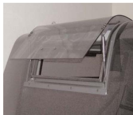
Durchdachte Lösungen im Detail zeichnen die SPACECAB-Familie aus: Hochklappbare Bänke erhöhen bei Bedarf die Transportkapazität, der Einstieg ist extrabreit und vor allem barrierefrei (Rollstuhlgeeignet), das optionale Ausstellfenster verbessert das Raumklima noch weiter.
