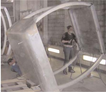
**3.** In der Vormontage erfolgt der Einbau der Innenverkleidungen und der Böden, sowie der angesetzten Teile.
