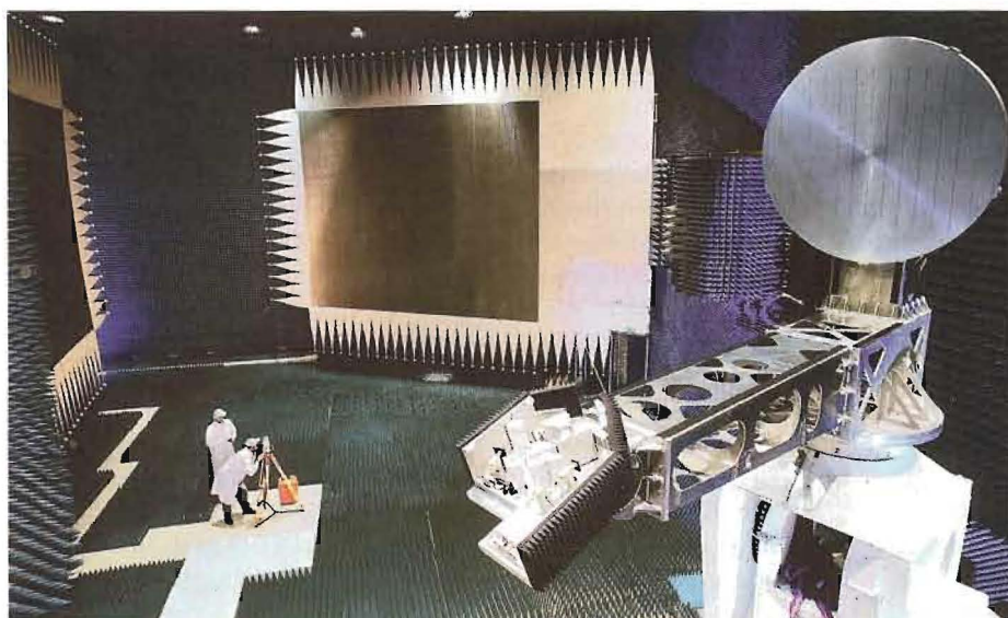
In der Simulationskammer wird über Parabol-, Hyperbol- und Parallelspiegel die Antennencharakteristik von Satelliten gemessen.
