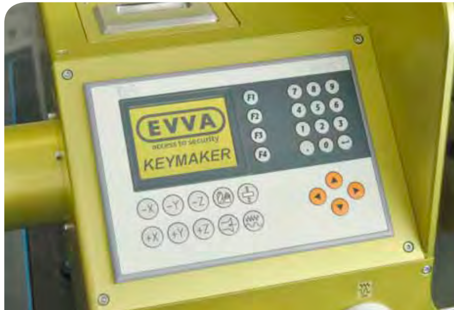
Gesteuert wird der Keymaker von einem Power Panel, die Benutzerführung ist mehrsprachig.
