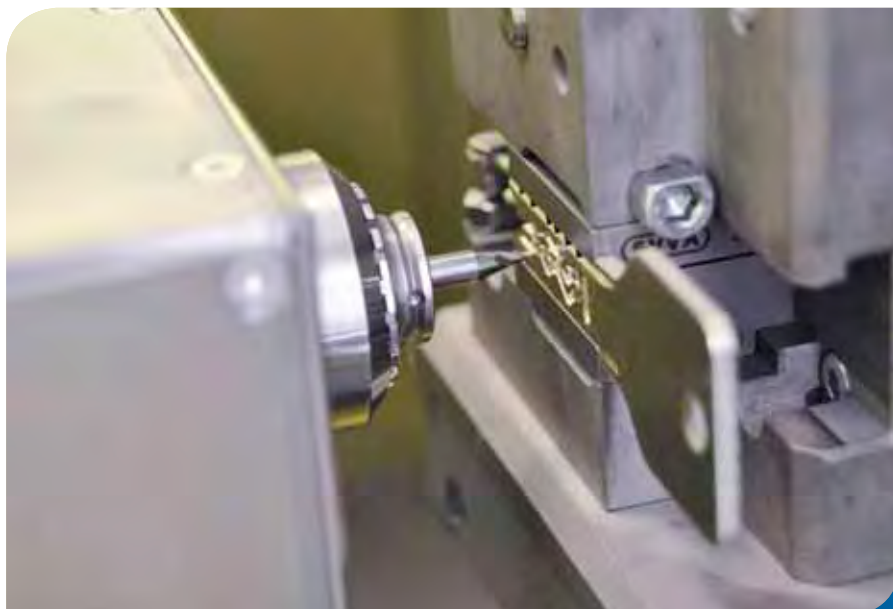
Ihre individuelle Codierung erhalten die Schlüssel durch 3D Fräsbearbeitung.
