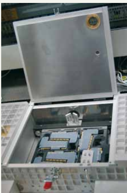
In drei solchen Kammern werden die X20 Analogmodule bei 60° C 100 % getestet.
