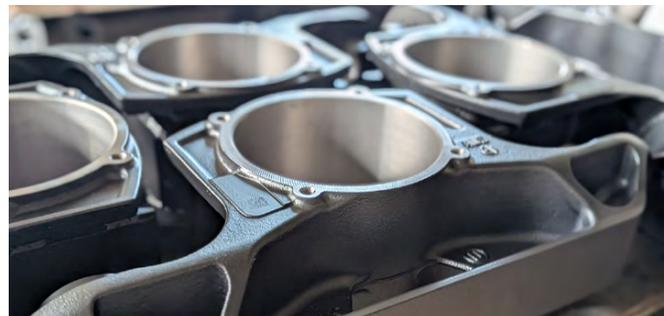
Kernaktivität der Silbitz Group Staßfurt AWS GmbH ist die mechanische Bearbeitung von Radsatzlagergehäusen aus Eisenguss und deren Komponenten.
