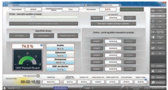
Ohne manuelle Datenerfassung steht am Panel – zugriffsgeschützt via RFID-Login – und online über Web-Clients stets eine aktuelle OEE-Übersicht zur Verfügung.
