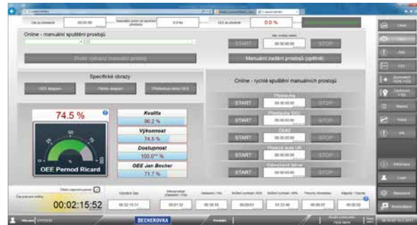
Abbildung 2: Ohne manuelle Datenerfassung steht am Panel – zugriffsgeschützt via RFID-Login – und online über Web-Clients stets eine aktuelle OEE-Übersicht zur Verfügung.
