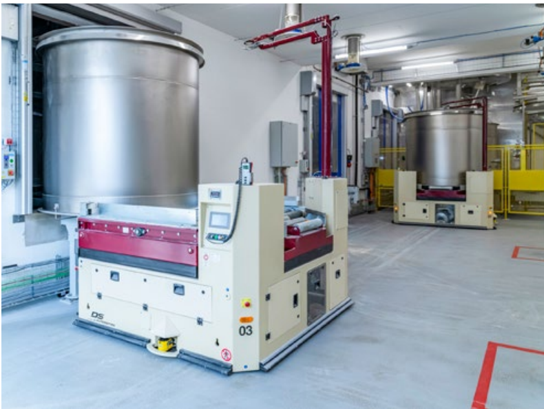
Das Fahrerlose Transportsystem bedient zahlreiche Schnittstellen zu anderen Systemen wie dem MES-System, Kettenförderern, Schiebe- und Rolltoren und verschiedenen SPS-Steuerungen.
