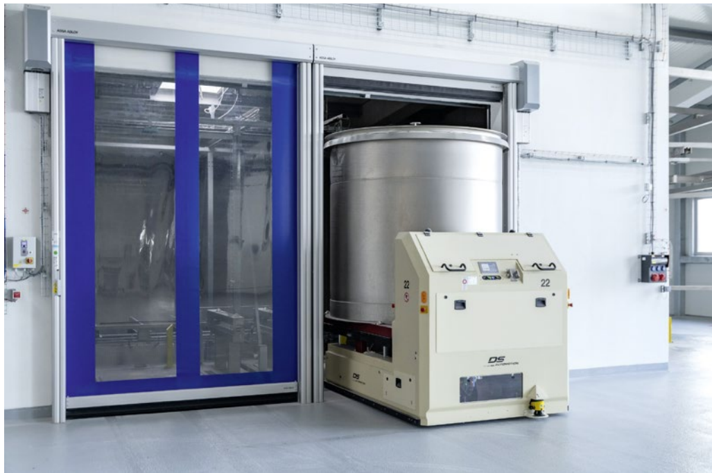
Ebene 2: Mobile Roboter unterfahren die Container und bringen sie zu den vier Entleerungsplätzen.
