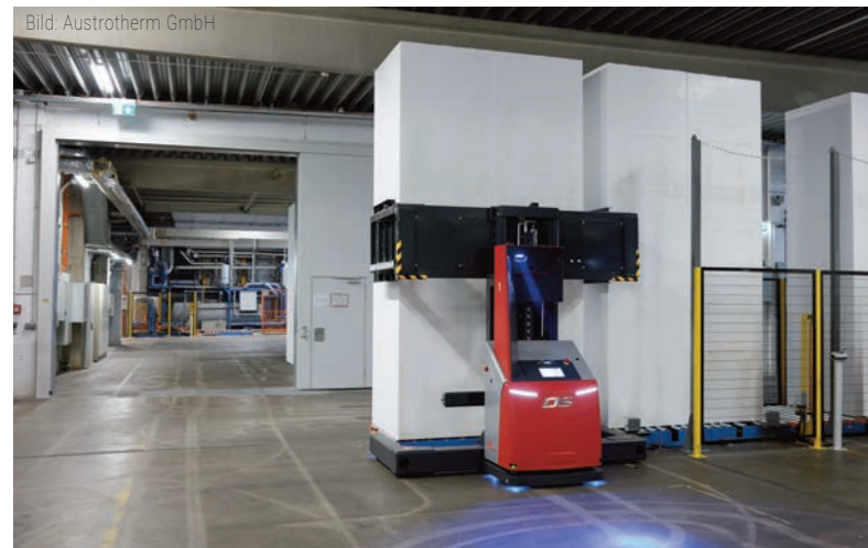
Vier fahrerlose Hochhub-Stapler Amadeus Grip mit einem Klammerhubgerüst transportieren die EPS-Blöcke in der Regel paarweise von den Blockformmaschinen in ein Reiflager und von dort zu den Schneidstraßen, manche davon über eine Blockpresse.
