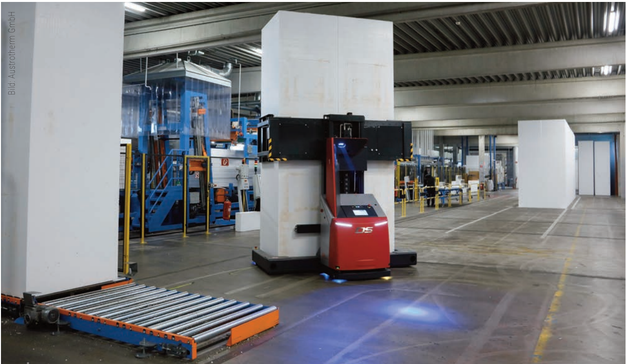
Im Austrotherm-Produktionswerk Pinkafeld transportiert ein fahrerloses Transportsystem von DS Automation rund um die Uhr Polystyrol-Hartschaum-Blöcke mit 4.080mm Höhe, 1.040mm Länge und max. 1.290mm Breite.
