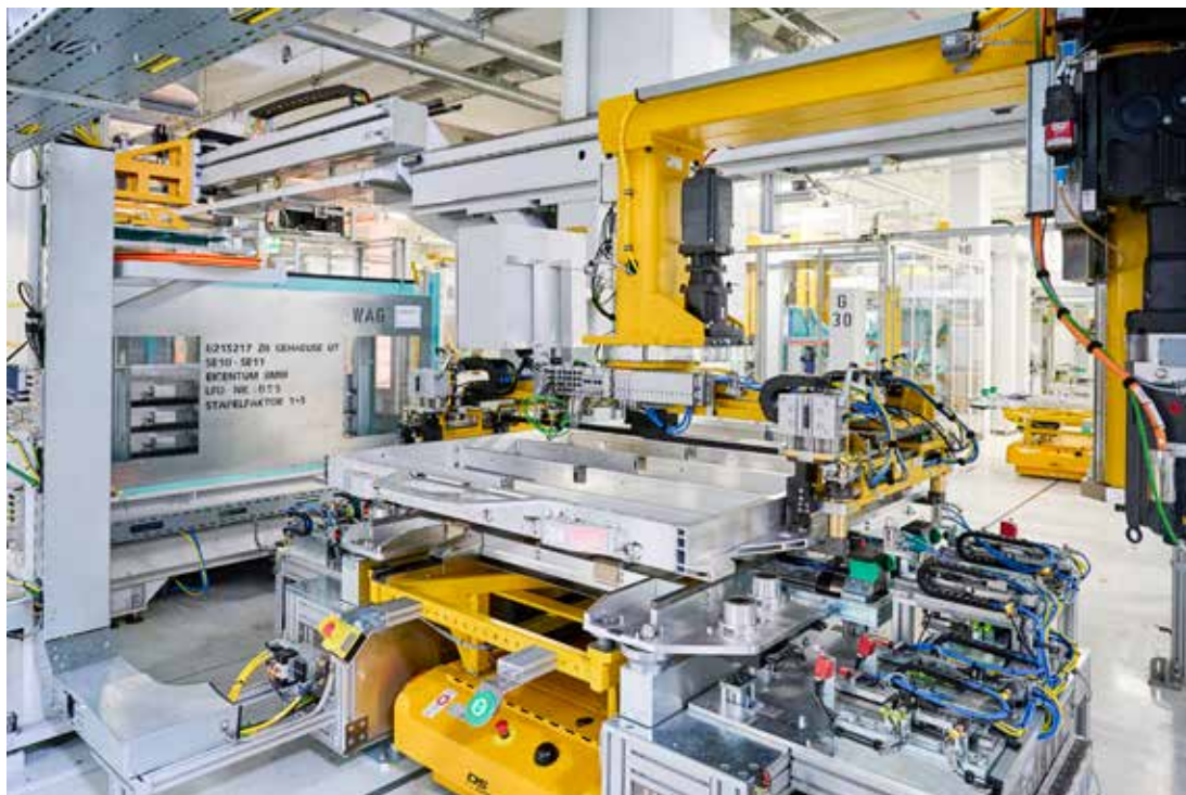
Die durch Differenzialantrieb äußerst wendigen, anwendungs-optimierten Fahrerlosen Transportfahrzeuge von DS Automation können auch im Rückwärtsgang in die Montagezellen einfahren und sind in allen Batteriemontagelinien dieses Herstellers weltweit im Einsatz.
