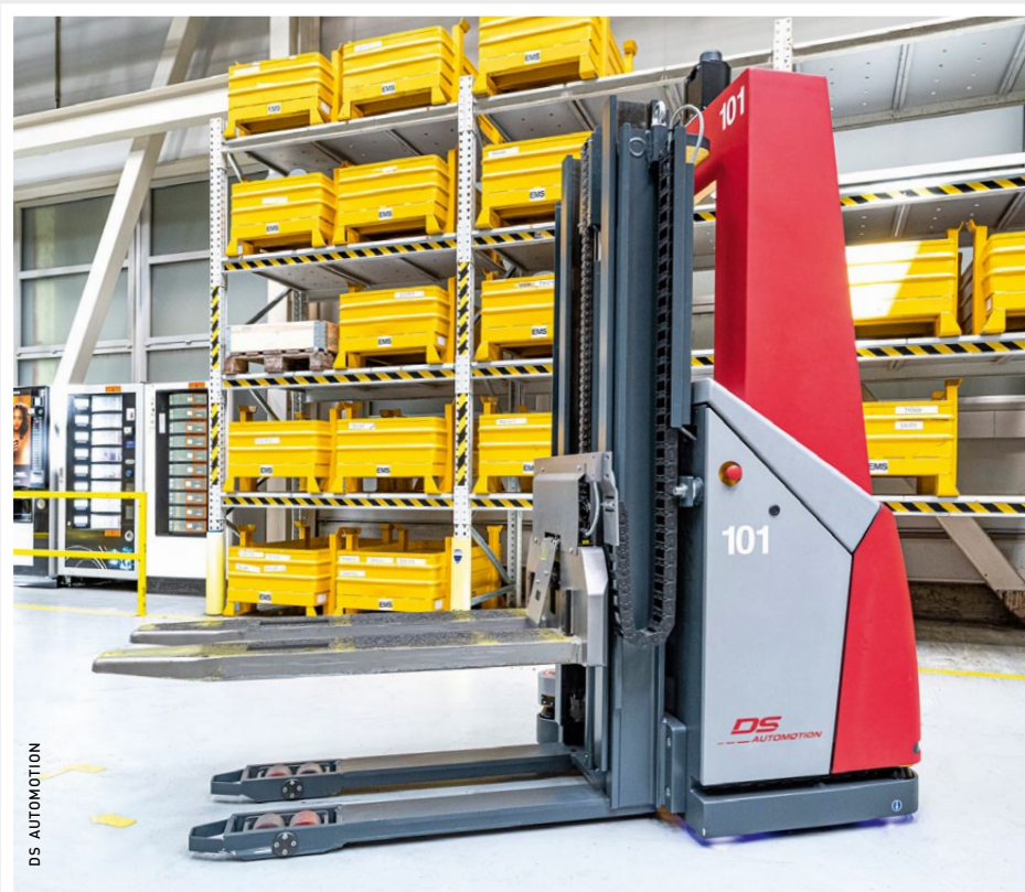
„Amadeus“ begegnet dem Kleinlasten-FTF „Sally“ von DS Automotion, das per Konturnavigation hauptsächlich Werkzeuge und Messmittel zu den Bearbeitungszentren bringt.
