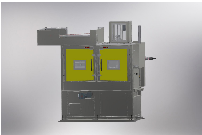
Das Air Knife und der Werkstück-Stopper sowie die Schotte auf beiden Seiten des Bearbeitungsraums werden pneumatisch betätigt.
