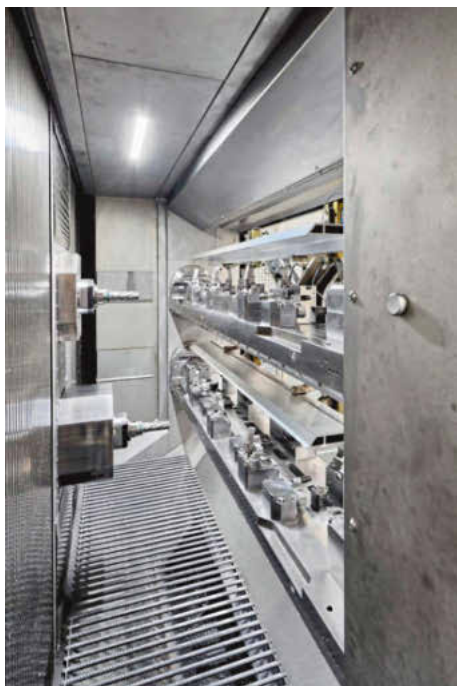
In jedem der beiden Maschinenräume der Synchronmill Q sind zwei horizontale Bearbeitungsspindeln angeordnet. Bild: ©raumpixel
