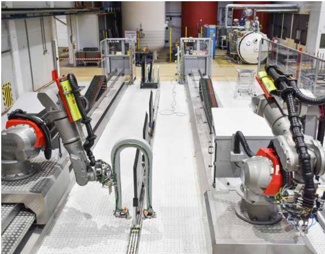
Mit zwei Knickarmrobotern auf parallel verlaufenden Linearachsen kann die ACCUBOT-Anlage von Fill in drei getrennten Zonen Composite-Bauteile zerstörungsfrei prüfen.
