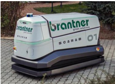
■ Eine von der Kunst-Universität Linz gestaltete Abdeckung macht den autonomen mobilen Roboter SCARAB allwettertauglich.
