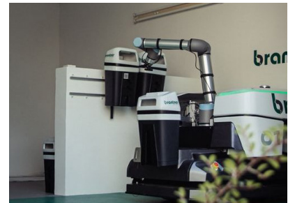
■ In der Basis erfolgen Entleerung, Reinigung und Kontrolle der Behälter, während der Roboter seine Akkuladung ergängt.
