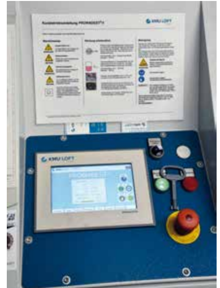
Die Steuerung mit SPS stellt den vollautomatischen Betrieb der Anlage sicher. Ein Touch Panel mit bedienerfreundlicher Menüführung und Direkthilfe erleichtert Anpassungen.
