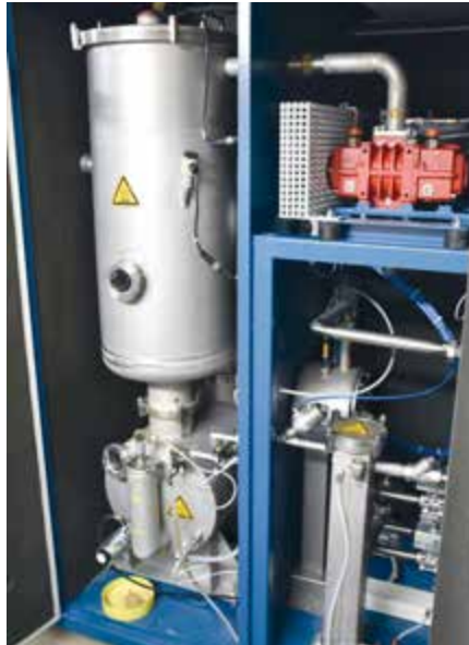
Prowadest P60/1 arbeitet nach dem Prinzip des Zwangsumlaufs und ist bei nur 1.790 x 920 mm Aufstellfläche für eine Jahresleistung von 360 m 3 ausgelegt.
