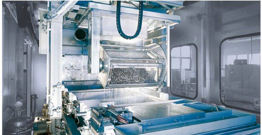
oben: Ein Fördersystem bringt die Drehgestelle mit den Reinigungskörben von Becken zu Becken. In jedem davon werden diese zum Erzielen einer optimalen Reinigungswirkung axial gedreht und zugleich senkrecht bewegt.
