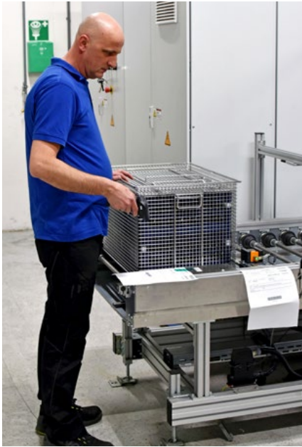
oben: Ein Fördersystem bringt die Drehgestelle mit den Reinigungskörben von Becken zu Becken. In jedem davon werden diese zum Erzielen einer optimalen Reinigungswirkung axial gedreht und zugleich senkrecht bewegt.
