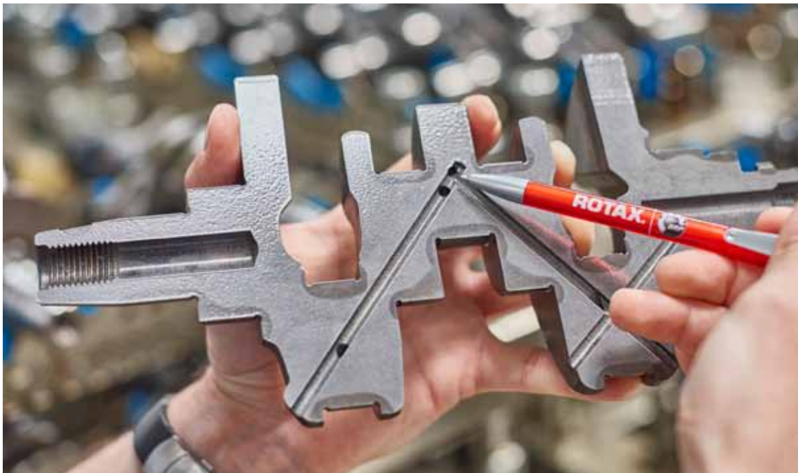
Elektrolytisch und manuell durchgeführt, war das Entgraten der langen und komplexen Ölversorgungskanäle eine Herausforderung.
