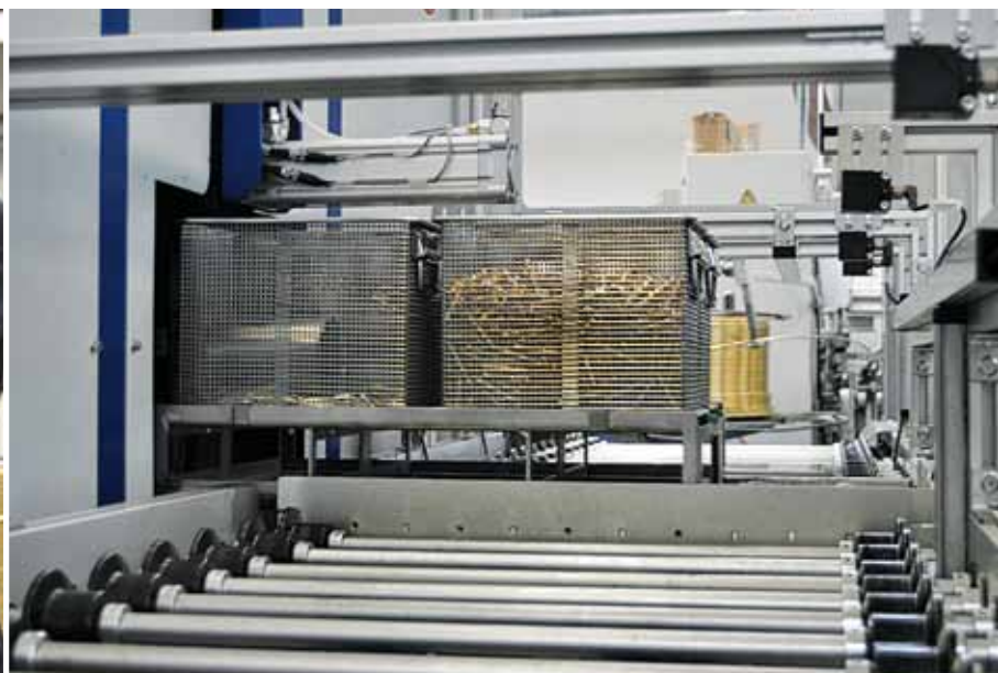
Einzug und Ausstoß der Reinigungskörbe erfolgen automatisch, die Reinigung findet hinter verschlossener Luke im Vakuum statt. Das verkürzt die Trocknungszeit enorm, macht häufige Medienwechsel überflüssig und ermöglicht die automatisierte Rückführung des Öls in den Kühl-/Schmierstoffkreislauf.
