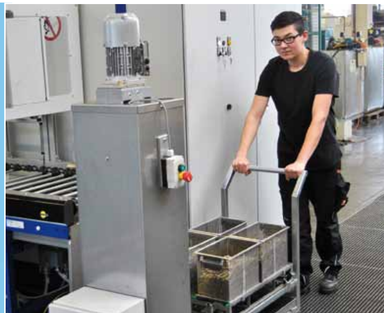
Die Herstellung der Kontakte erfolgt bei PC Electric auf Rundtaktmaschinen – danach geht es direkt in die Reinigungskörbe. Je vier davon werden zur Beladung der Reinigungsanlage Universal 81C von Dürr Ecoclean mit Hilfe einer im Haus konstruierten Hebeanlage auf Arbeitshöhe gebracht.
