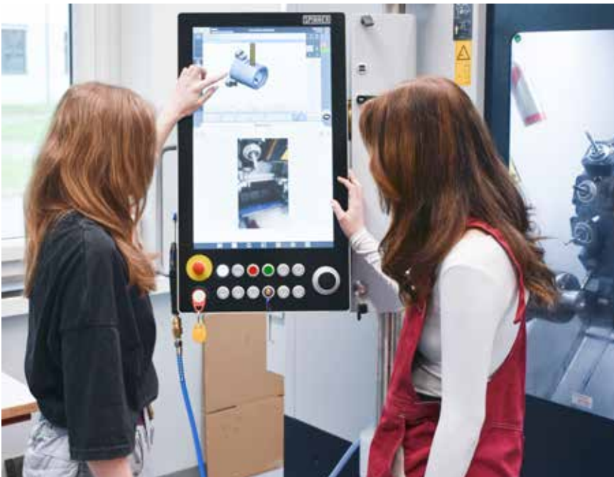
Die Ausstattung der Maschinen mit einem Visualisierungspaket ermöglicht das Beobachten der Vorgänge im Arbeitsraum sowohl auf den Steuerungsbildschirmen als auch auf einem abgesetzten Smart Board.
