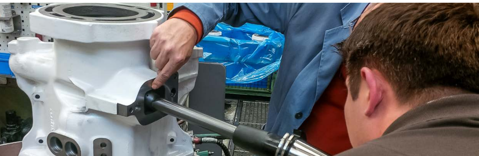
Im Inneren von Abgasführungsgehäusen aus Grauguss – je eines für zwei Zylinder – werden mit zwei Schrauben pro Zylinder die aus hitzebeständigen Blechen gefertigten Abgasleitsysteme fixiert.
