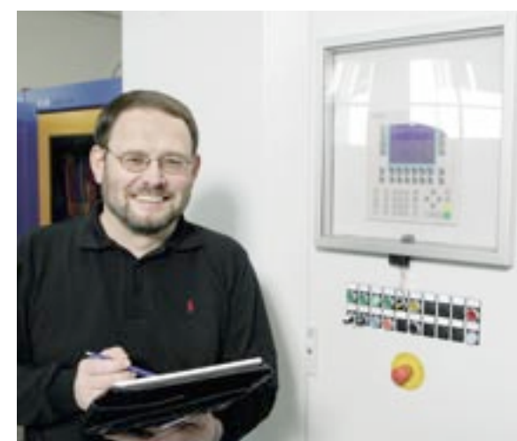
Saubere Sache: Bedienkonsole einer Fill-Anlage zur Ski-Erzeugung. Die Ausnehmungen für die Türreinbauten werden im Bearbeitungszentrum des Rittal Vertriebs- und Logistikcenters Linz mit CAD-Daten von Fill hergestellt.
