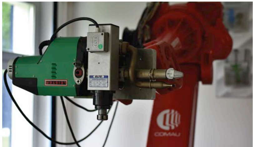
Studierende am Umwelt-Campus Birkenfeld bauten eine hybride Maschine für die konventionelle und additive Fertigung mit einem Sechssachs-Roboter, der mit einem Extruder für den 3D-Druck und einer Spindel für die anschließende Bearbeitung ausgestattet ist. Die NC-Programme dafür werden ausschließlich mit NX CAM erzeugt und simuliert und anschließend in die Robotersteuerung übertragen.
