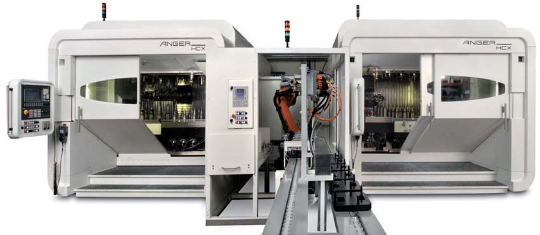
Komplexer Bearbeitungsprozess mit 2 ANGER HCX Anlagen und Roboterbeladung für einen führenden Automobilkonzern.
