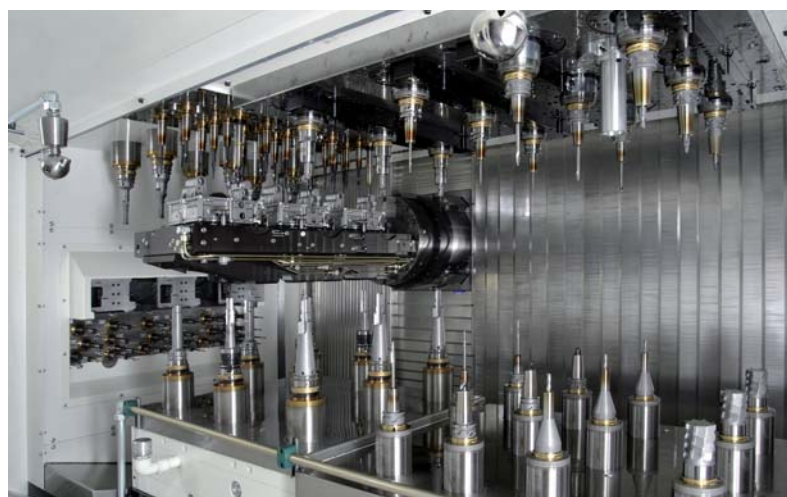
Der bewegliche Werkstückträger wird zur Bearbeitung gegen die über 80 Bearbeitungsspindeln geführt.
