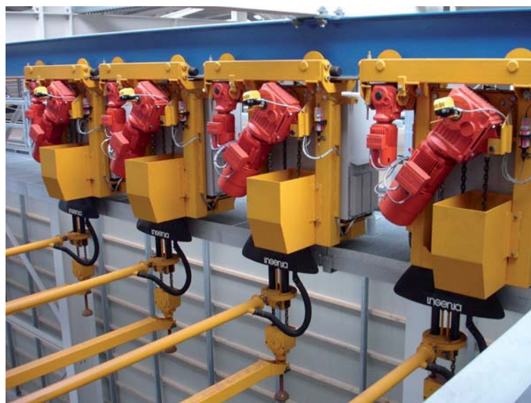
Die mittels Frequenzumrichter stufenlos gesteuerten fahrerlosen Transporteinheiten mit lastabhängiger Hubwerksregelung verkehren nicht nach Fahrplan, sondern ereignisgesteuert.
