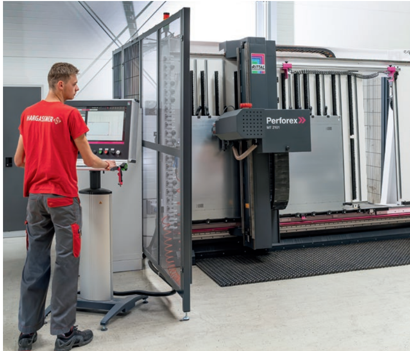
Links: Mit Eplan Smart Wiring wird jeder Schritt bei der Verdrahtung visualisiert. Oben: Mit dem Bohr- und Fräszentrum Perforex von Rittal lassen sich Schaltschränke automatisiert bearbeiten.
