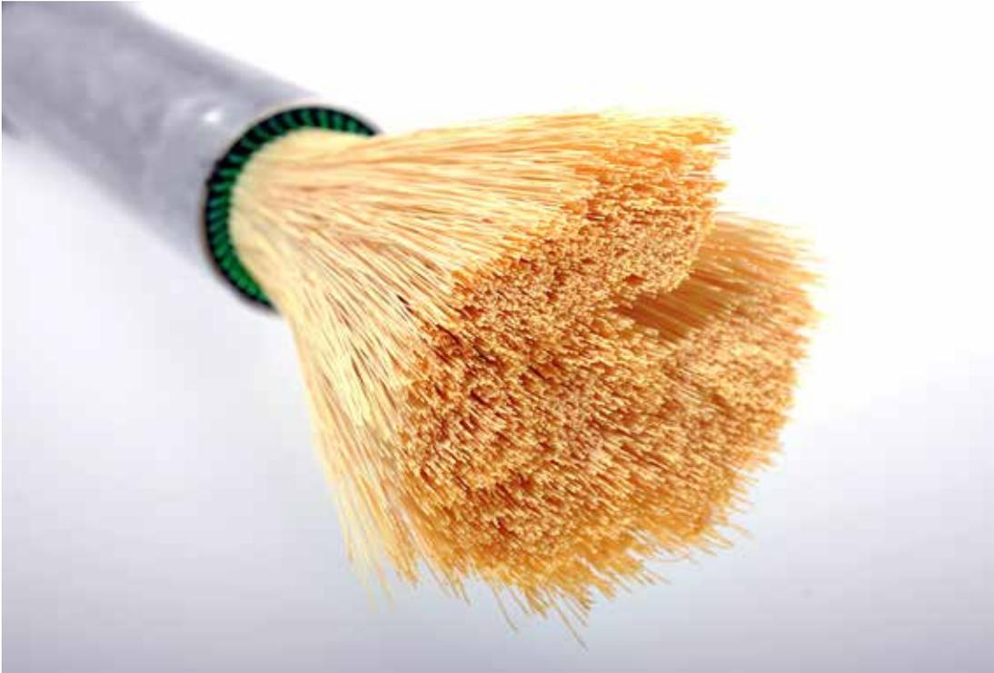
Die SEPURAN®-Membranen erinnern an Makkaroni und bestehen aus einem **eigens entwickelten Hochleistungskunststoff** aus dem Evonik-Werk in Lenzing.
