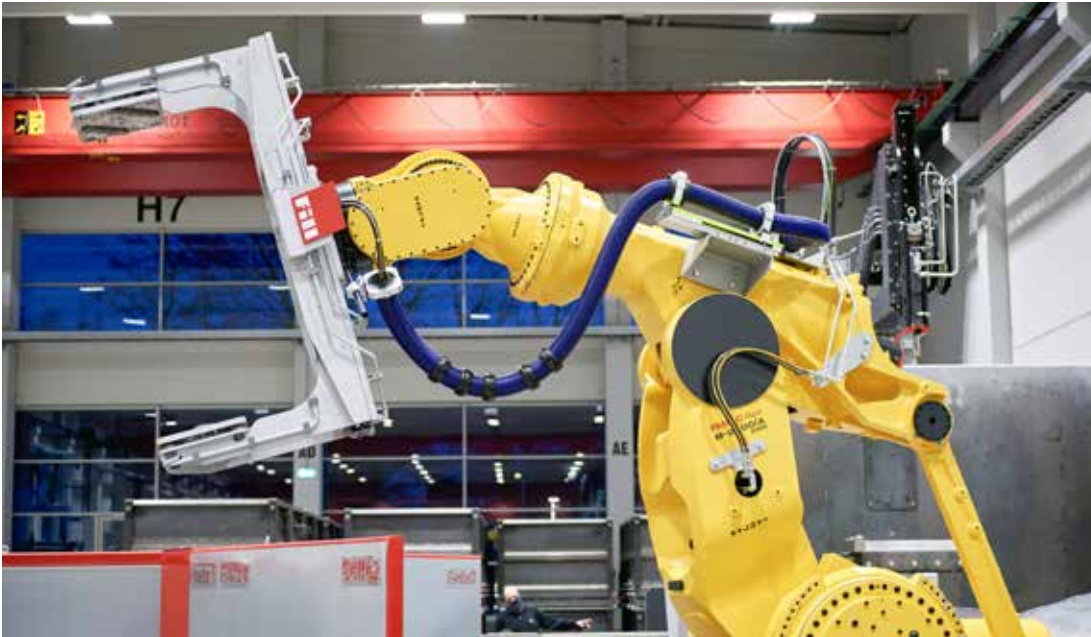
Wegen des Gesamtgewichtes von Teil und Kern von bis zu 1,8 Tonnen war das Teilehandling bisher nur mit starren Portalanlagen möglich. Der Schwerlastroboter M-2000iA/2300 von Fanuc mit 2,3 Tonnen Tragfähigkeit ermöglichte die Flexibilisierung des Teilehandlings.
