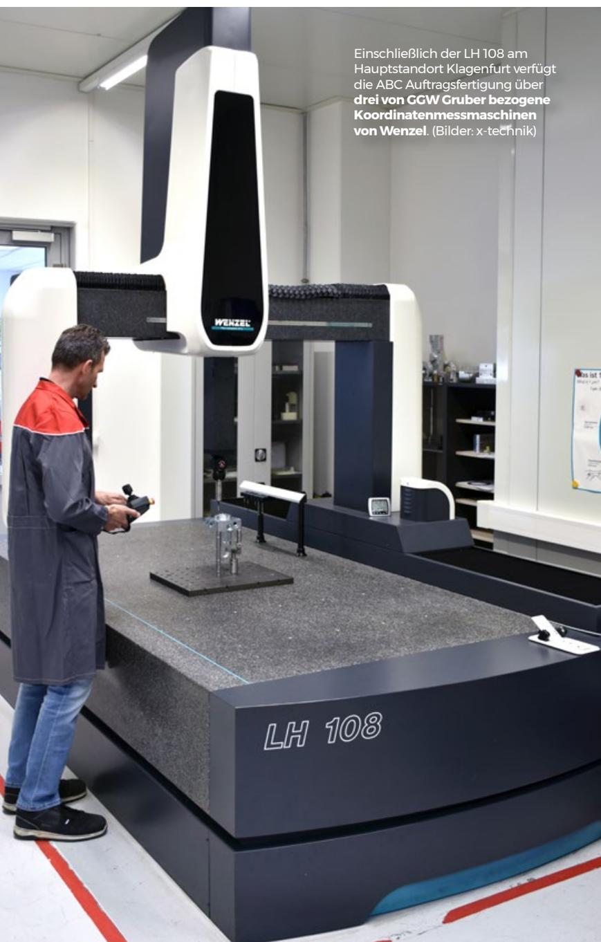
Einschließlich der LH 108 am Hauptstandort Klagenfurt verfügt die ABC Auftragsfertigung über drei von GGW Gruber bezogene Koordinatenmessmaschinen von Wenzel. (Bilder: x-technik)
