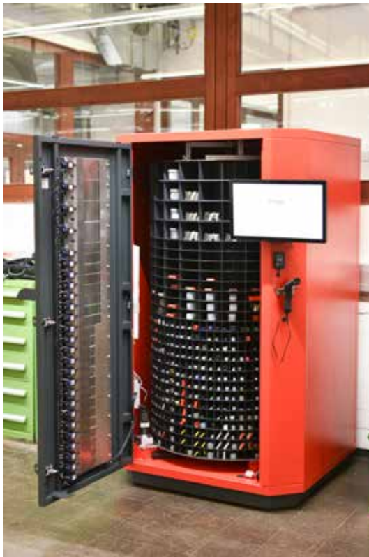
Zwei Kunststoff-Grundelemente gestatten die Konfiguration des Fächer-Karussells mit bis zu vier verschiedenen Fachgrößen für unterschiedliche Teiledimensionen.
