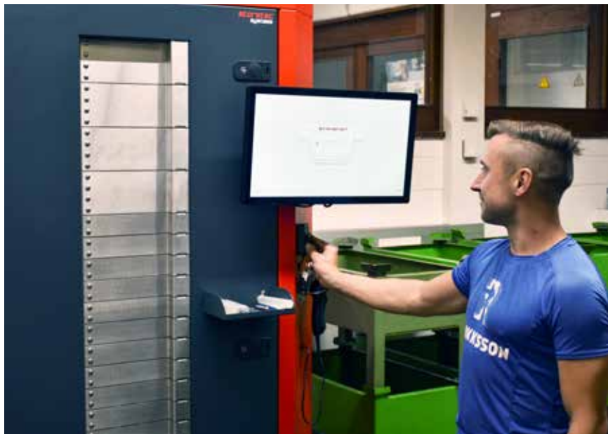
Nach Anmeldung am RFID-Leser erfolgt die Werkzeugauswahl am komfortablen Auswahlfenster oder per Barcode-Scan.
