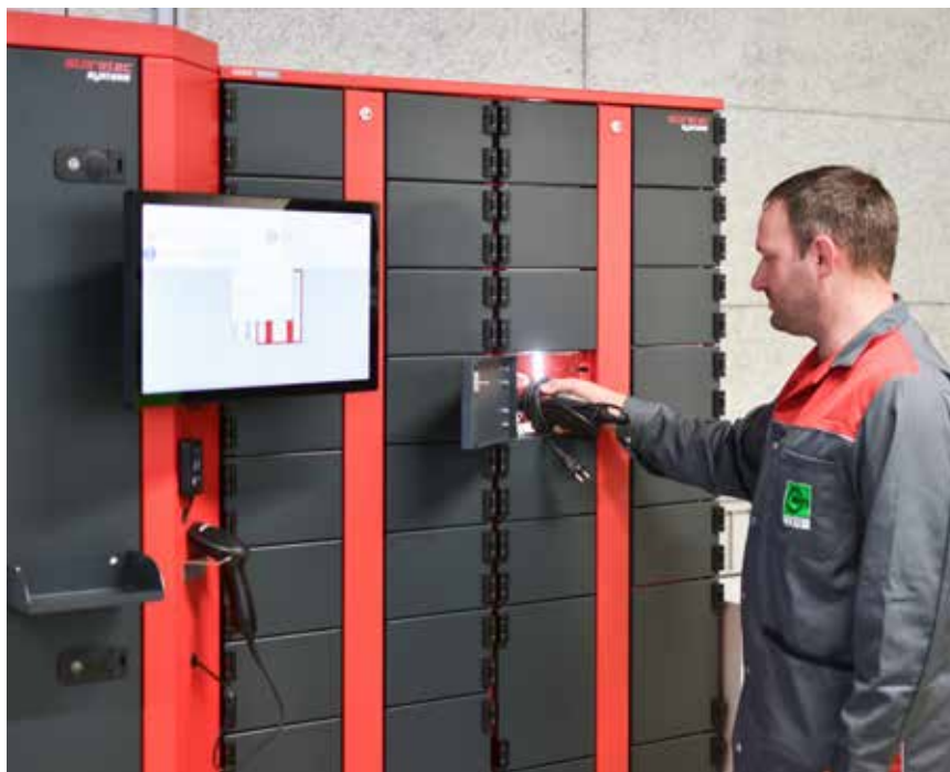
Im Fachbereich Metalltechnik bietet eine Kombination bestehend aus einem StoreManager Pro und einem StoreManager Locker zusätzliche 48 Fächer für größere Handwerkzeuge , z. B. Winkelschleifer.
