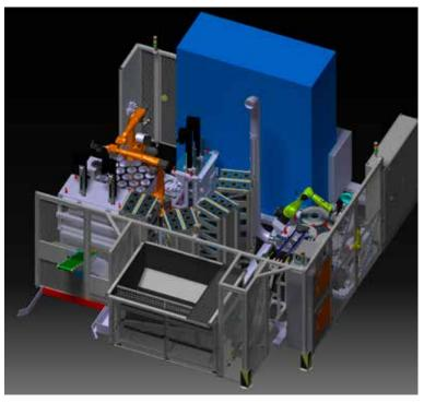
INDAT entwickelte und baute eine hoch automatisierte Anlage mit besonders geringer Stellfläche, in der bis zu **acht Muffenrohlinge pro Minute mit vier verschiedenen Nennweiten** mechanisch bearbeitet und aufgeweitet werden. (Bild: INDAT)
