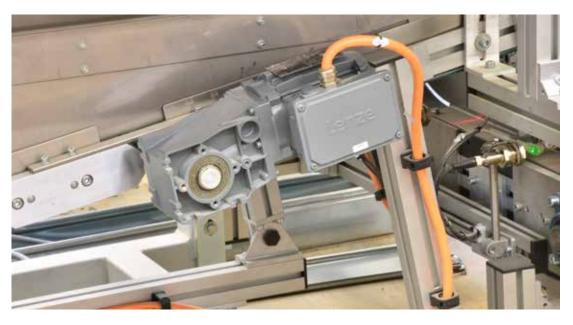
Für die unterschiedlichen Anwendungen sind in der Muffenaufweitungsanlage in Summe zwölf Motoren und Aktuatoren unterschiedlicher Größen und Bau**arten** verbaut. Im Bild ein Getriebemotor der Reihe g500 als Förderbandantrieb. (Bild: x-technik)
