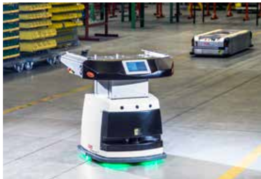
Das kompakte FTF Sally in der Traglastklasse bis 100 kg nutzt den Sicherheits-Laserscanner nicht nur für den Personenschutz , sondern auch zur Navigation anhand bekannter Umgebungsmerkmale.
