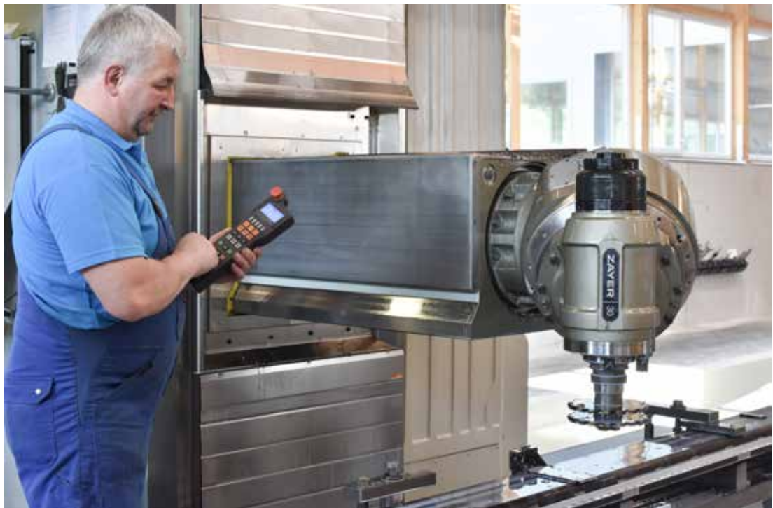
Zur Ausstattung der Zayer KAIROS gehört auch ein kabelloses Handrad für Einstellarbeiten außerhalb der Kabine.
