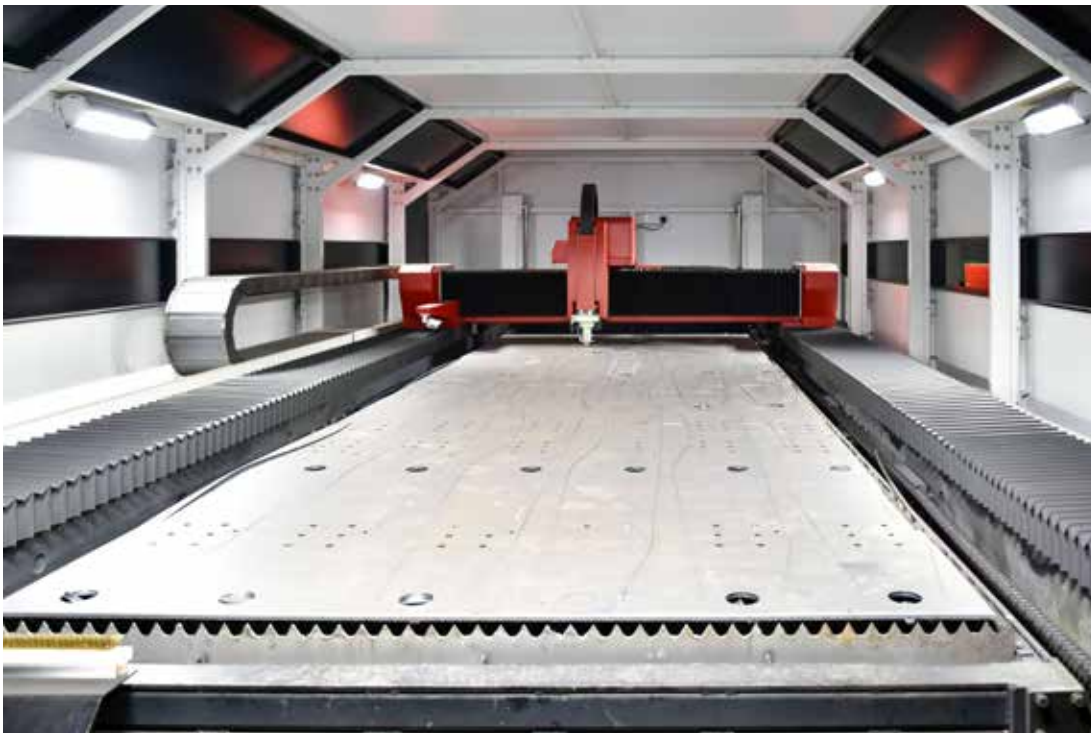
Die Speedline Fiber 2060 von TCI Cutting ist für 2 x 6 m große Blechtafeln geeignet und ersetzt eine in die Jahre gekommene CO 2 -Lasieranlage im selben Format.
