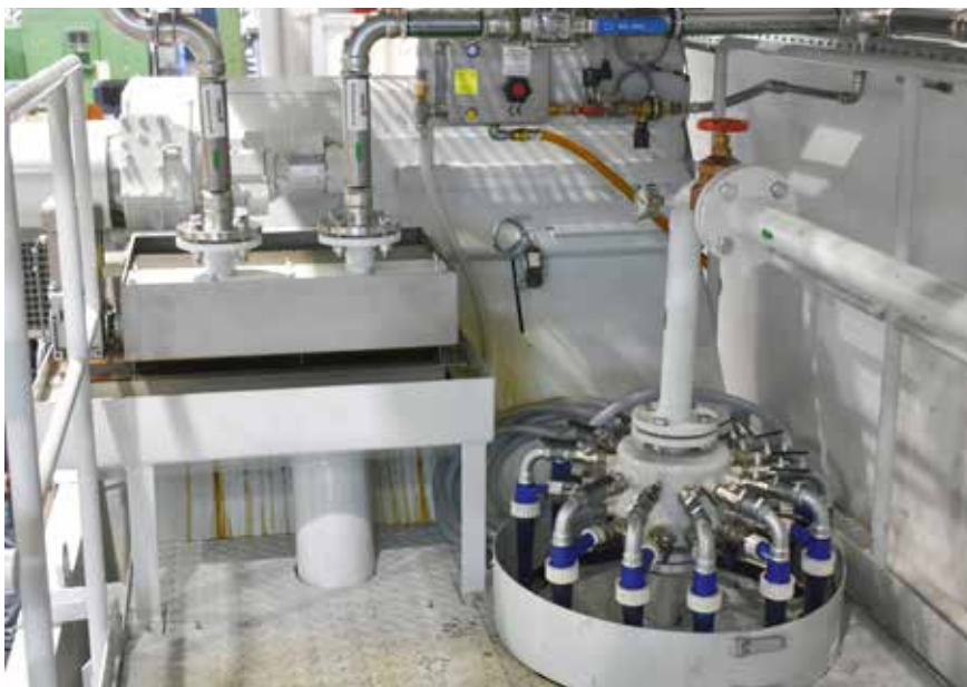
Der verunreinigte KSS gelangt über einen Magnetvorabscheider (links) in den Schmutzbehälter. Dort fallen die größeren Partikel aus und Zyklomat-Hydrozyklonen (rechts) separieren die verbleibenden Schmutzteile über 5 µm.
