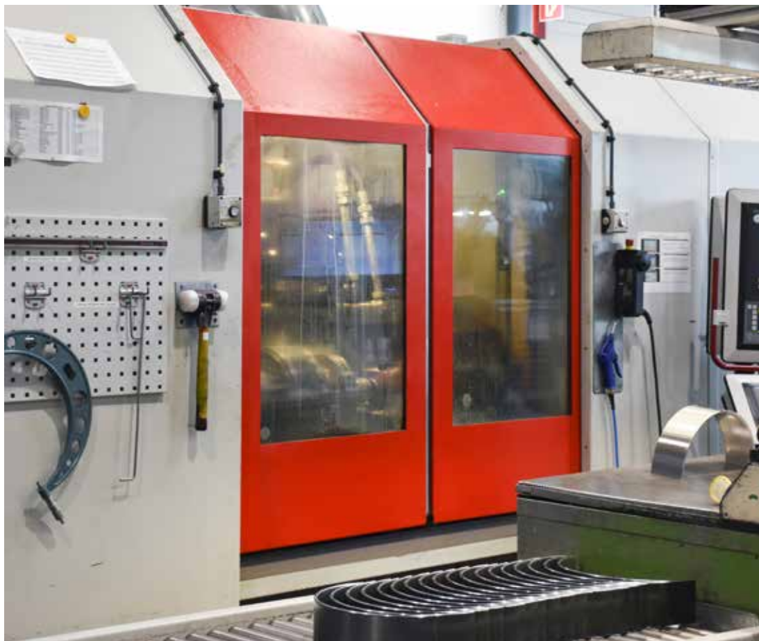
In drei Schichten erfolgt das Schleifen der Gleitlager-schalen auf Außen-Rundschleif-maschinen von Schaudt.
