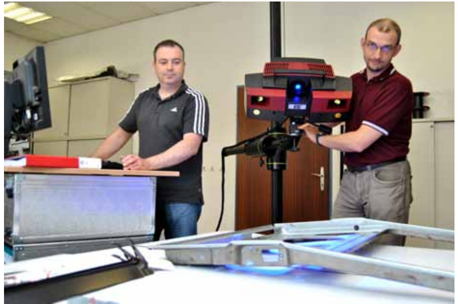
Der Zeitaufwand für das Erstellen valider Geometriedaten aus fertigen Teilen ist für Herbert Schneller (links) und Jürgen Rohrleitner, Konstrukteure Vogel & Noot Technologie mit dem ATOS II Triple Scan minimal. Die erzielte Datenqualität wäre mit klassischen Meßmethoden nicht oder nur mit exorbitantem Aufwand zu erreichen.
