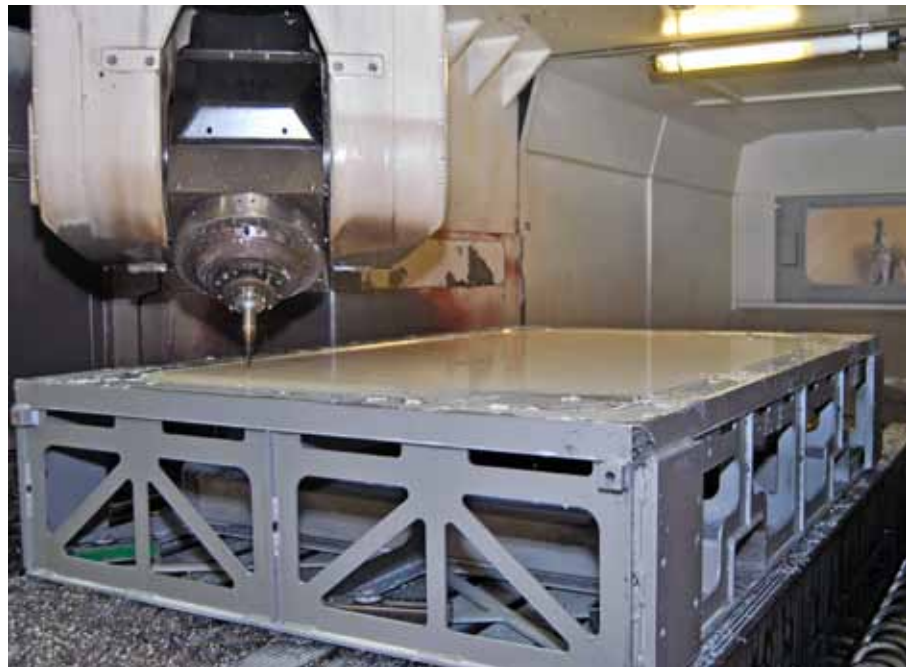
Ein Gabelfräskopf mit Hochleistungs-Elektrospindel garantiert im Zusammenspiel mit den hochdynamischen Linearachsen problemlose simultane Mehrachsbearbeitungen der großen Werkstücke bei hohen Zerspan- und Vorschubgeschwindigkeiten.
