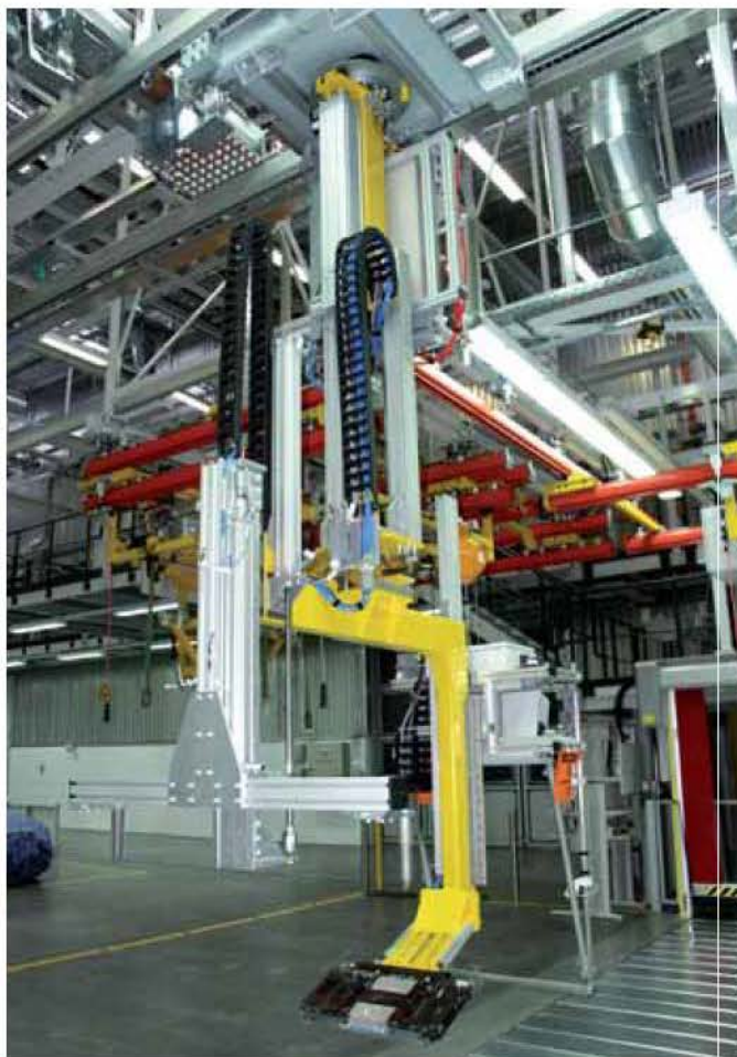
Bereit zum Einsatz: Mit diesen Handhabungsgeräten bauen MitarbeiterInnen mit Behinderung ergonomisch und ohne körperliche Anstrengung Cabrio-Dächer präzise in Automobile ein.
