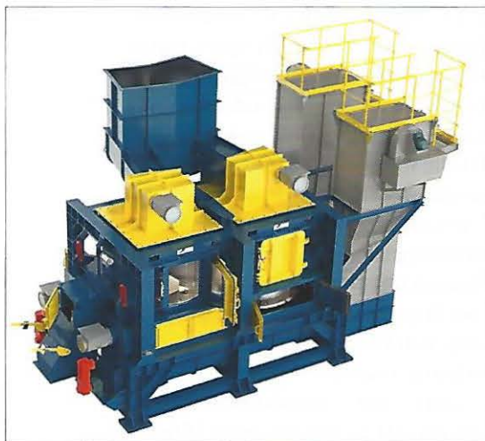
Die Rocket Mill RM 2.50 double des Kärntner Anlagenherstellers A TEC Production & Services GmbH macht aus Kunststoffabfällen wertvolle Sekundärbrennstoffe. Die komplexe Elektrodokumentation der Rocket Mill stammt von ATe-s und wurde weitgehend automatisiert mit eccad entwickelt.
