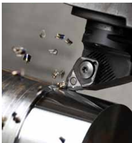
Seco Tools beliefert die HTL Neufelden mit modernster Werkzeugtechnologie wie hier mit der extrem verschleißfesten Duratomic® Sorte TP0500 bei der Stahldrehbearbeitung.
