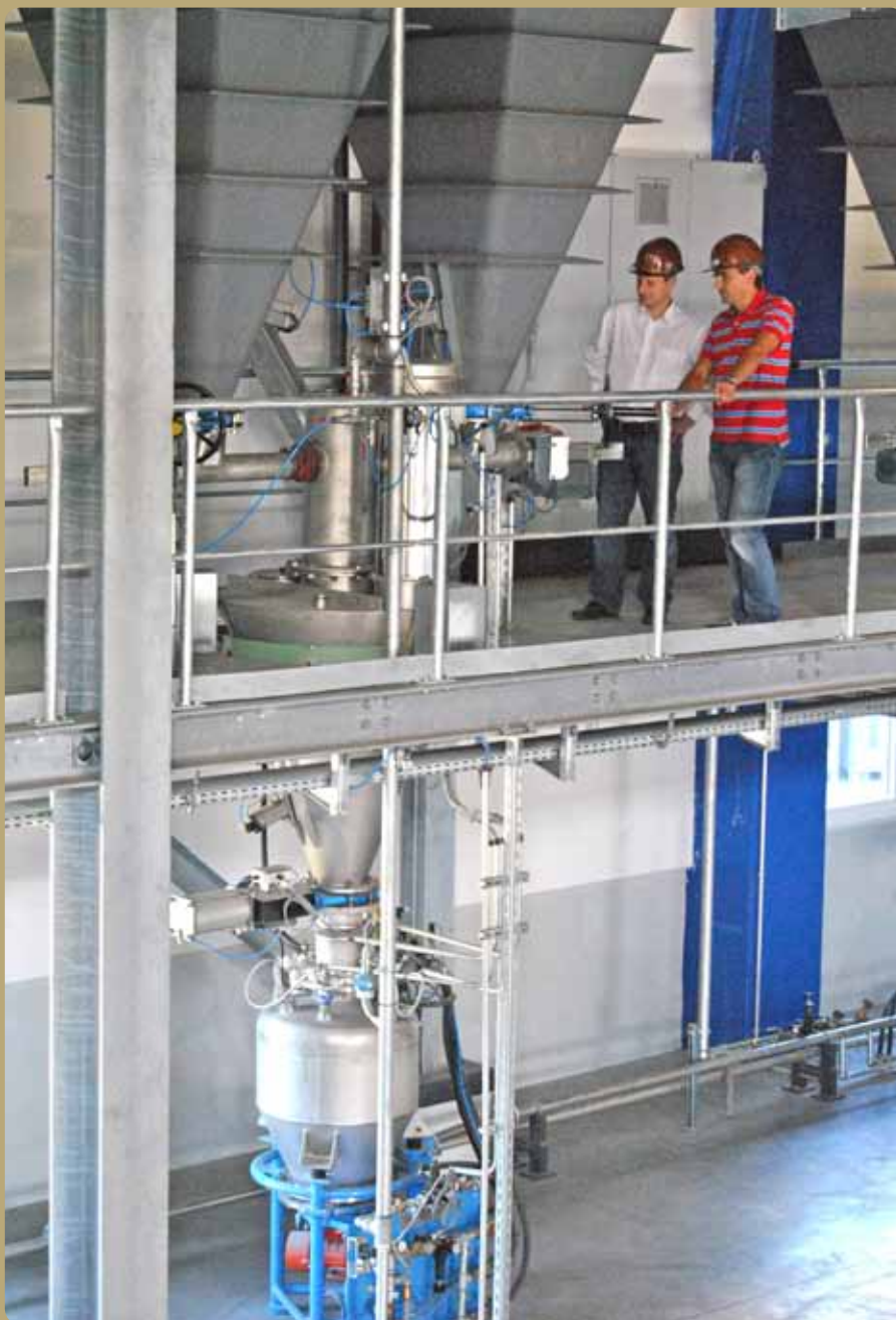
Führender Hersteller von Metallsulfiden ist Tribotecc. In ihrem Werk in Arnoldstein erzeugt sie synthetische Metallsulfide als reibungsstabilisierende Additive in einer vollautomatischen Produktionsanlage. Exakt dosiert werden dabei aus zahlreichen Behältern die Bestandteile zugeführt.
