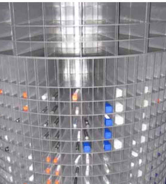
Zwei Kunststoff-Grundelemente gestatten die Konfiguration des Fächer-Karussells mit bis zu vier verschiedenen Fachgrößen für unterschiedliche Teilegrößen.
