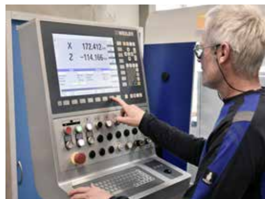
Die Weiler-Steuerung one1 mit 22"-Monitor erlaubt das Abrufen vorgefertigter Bearbeitungszyklen und verleiht der Maschine Flexibilität bei geringstem Programmieraufwand.
