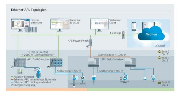
Ethernet-APL bringt **Datenraten bis 10 Mbit/s** gemeinsam mit der Energie-übertragung auf einer Zweidrahtleitung bei bis zu 1.000 m Reichweite.
